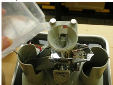
このししおどしの正式名称は「転倒ます」。「ます」は0.5ミリの雨が溜まると傾き、もう片方に雨水が流れ込む仕組みです。これなら雨水を捨てる手間はかからず、傾いた回数をカウントすれば雨量がわかります。例えば、1時間に10回カウントしたら $0.5 \times 10$ で5ミリの雨となります。
