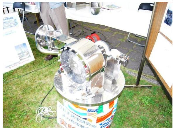
写真6 日置発電研究会小型水車発電機
